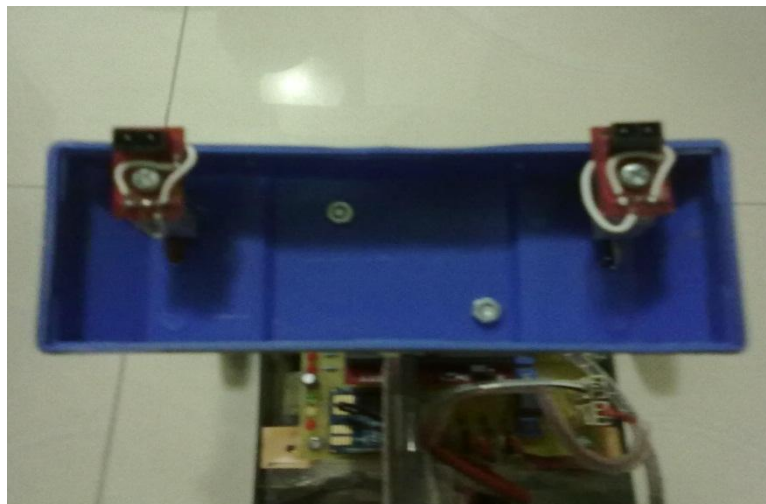
รูปที่ 3.13 ติดตั้งเซ็นเซอร์ไว้ที่ปลายแปลงลบกระดาน
