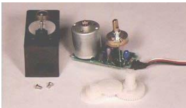
รูปที่ 2.6 การถอดชิ้นส่วน Servo motor
