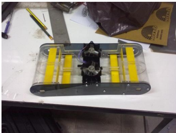
รูปที่ 4.1 โครงประกอบของหุ่นไต่ผนัง
