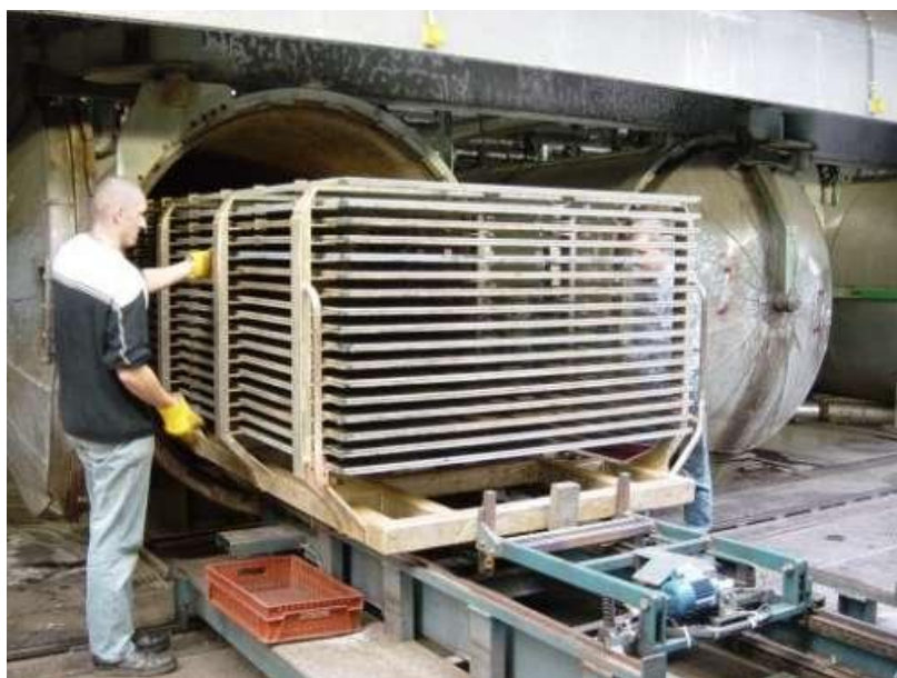
รูปที่ 2.13 แม่พิมพ์ผลิตแผ่นอะคริลิกพลาสติกเรียงซ้อนกันหลายชั้น
