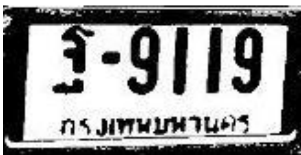
รูปที่ 2.9 แสดงภาพหลังการทำ Thresholding
